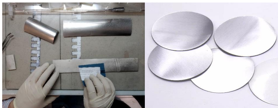
Рисунок 8 - Разрезанные части алюминиевой фольги в качестве анода
